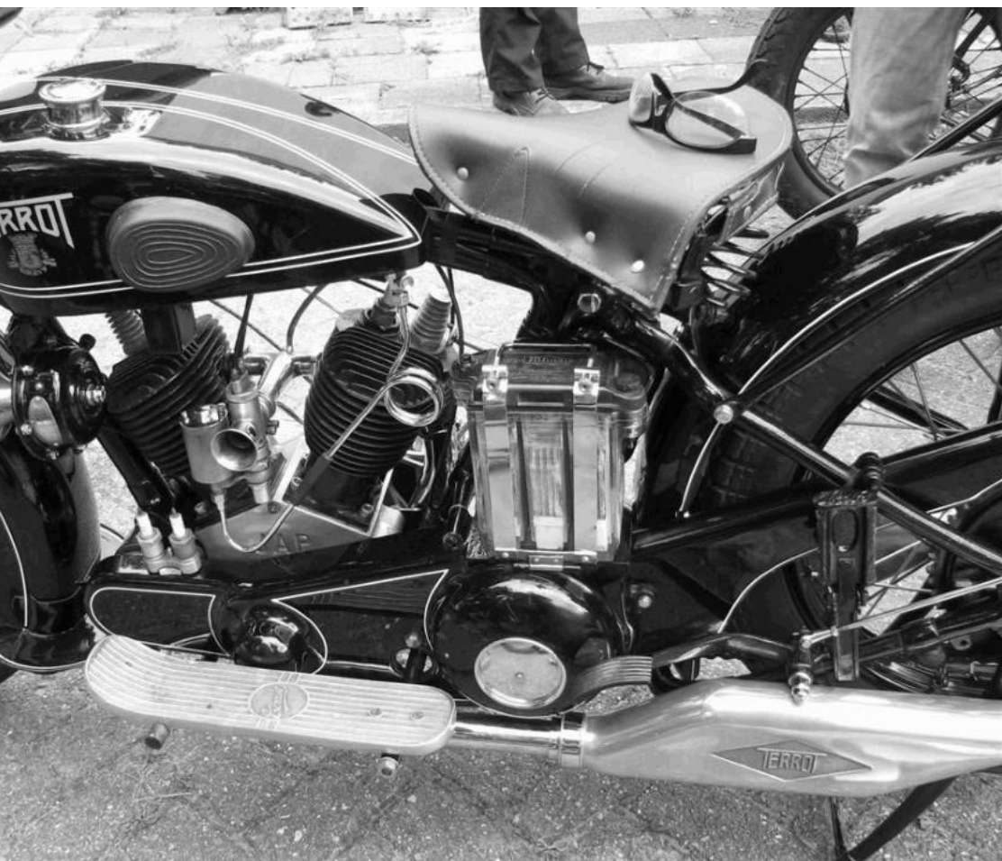
Prachtig gerestaureerde Terrot V twin uit 1931 van Ben Dirks: het betreft het type 'V' met een 680 cc JAP zijklep blok. Dit model is slechts twee jaar gevoerd: 1931 en 1932. Zie hiernaast voor het aanschaf- en restauratie verhaal.
