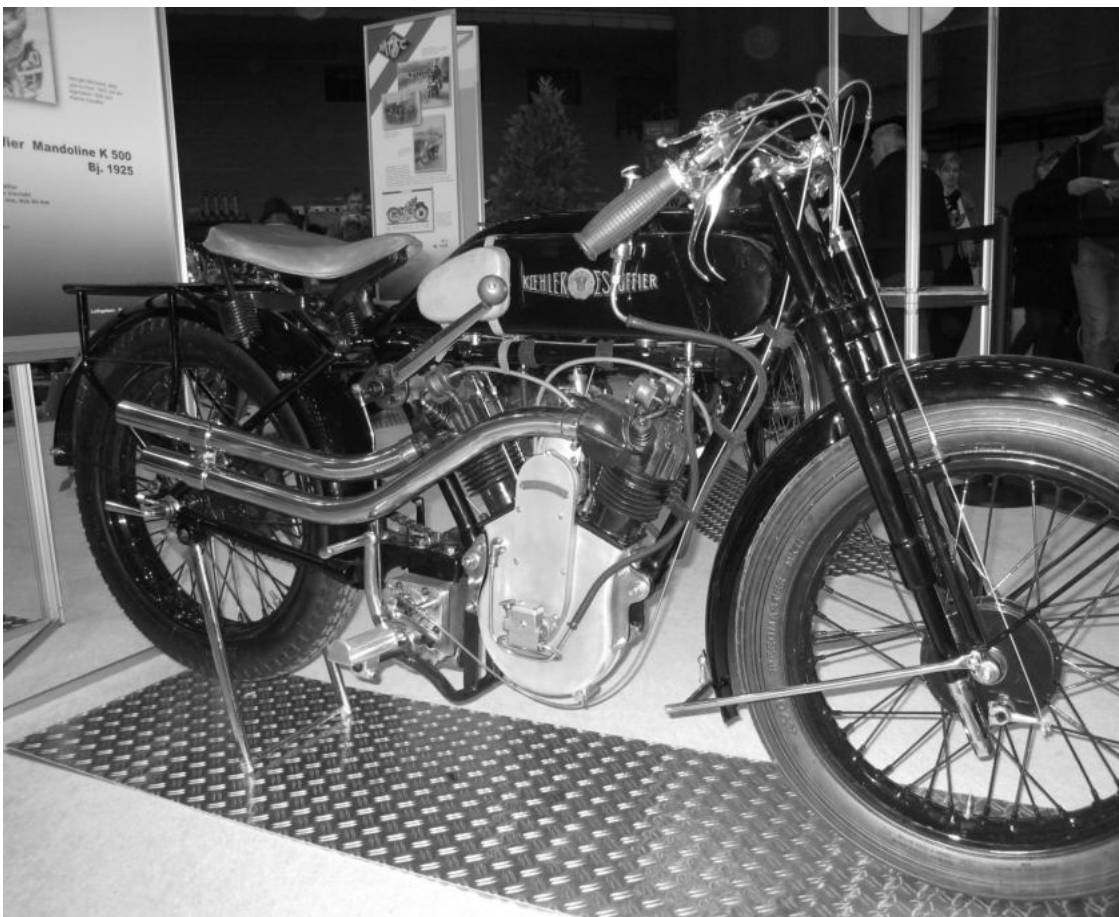
De beroemde "Mandoline" van Kiehler-Escoffier uit 1925. (Ontwerp Raymond Guiguet) 500 cc V twin. Het vermogen van de Sport uitvoering bedroeg 24 pk bij 4200 rpm. Dit model werd gebouwd van 1922-1928 De oorsprong van deze motor gaat terug tot 1912: toen bouwde Jules Escoffier reeds de voorloper van deze machine.
